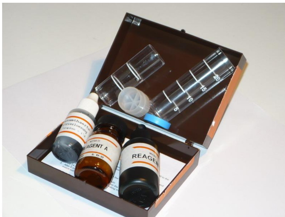
Kvapková porovnávacia súprava na rozbor vody určená pre informatívne potreby
